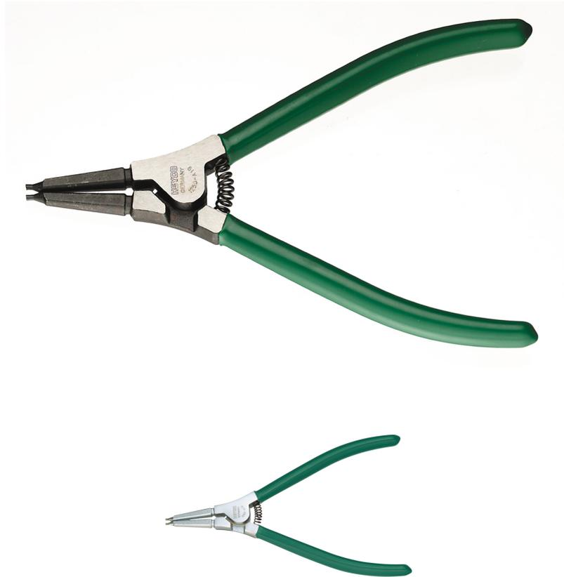
DIN 5254 A, Chrom-Vanadium, ASD = schwarz, Gelenk geschliffen, Griffe kunststoffbeschichtet, CPD = verchromt, Gelenk poliert, Griffe kunststoffbeschichtet, mit geraden Backen, Spitzen schwarz,, für Außen-Sicherungsringe (Wellen) nach DIN 471 + 983
