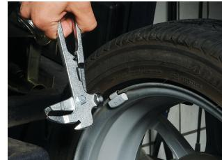
Chrom-Vanadium, C = verchromt, zum Befestigen, Lösen, Verschieben und Zuschneiden von Auswuchtgewichten, zum Anpassen der Haltefedern
