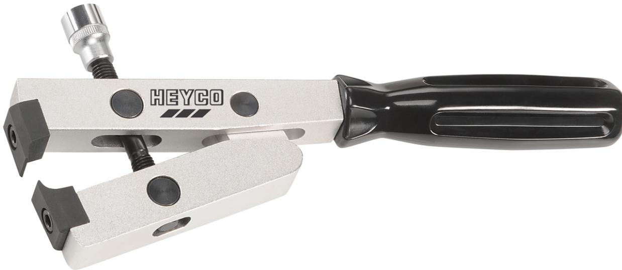
Zum Verklemmen von Spannbändern für Achsmanschetten und Schläuche, passend für Stahl und Edelstahlschellen, Gewichtsoptimiert durch hochfestes Luftfahrtaluminium, gehärtete Spannbacken, einfaches Einstellen des vorgeschriebenen Drehmoments über den 3/8" - Antrieb mit Hilfe eines Drehmomentschlüssels, Griff aus leicht abwaschbarem Kunststoff, max. Öffnungsweite: 45 mm, max. 30 Nm Anzugsdrehmoment Drehmomentschlüssel vorgeschrieben (sonst Bruch)
