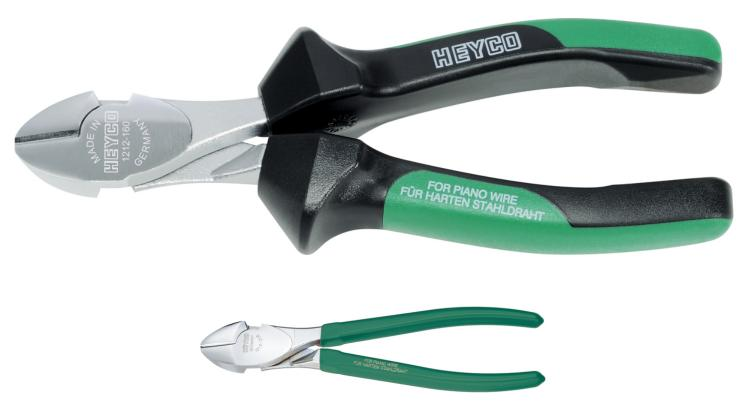
DIN ISO 5749, Spezialstahl, CPD = verchromt, Kopf poliert, Griffe kunststoffbeschichtet, CPI = verchromt, Kopf poliert, formel plus Kunststoffgriffe mit Abgleitschutz, Schneiden zusätzlich induktiv gehärtet, für harten Draht (Piano-Draht)
