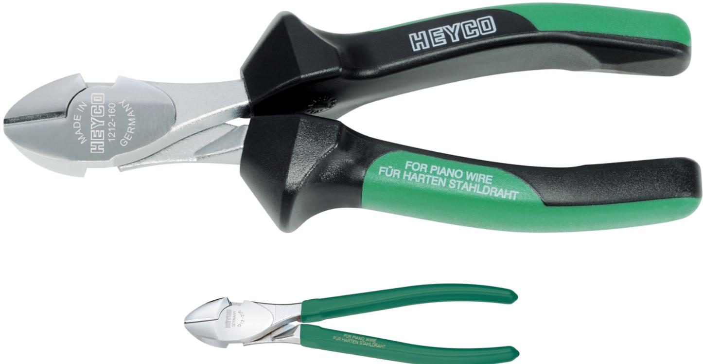
DIN ISO 5749, Spezialstahl, CPD = verchromt, Kopf poliert, Griffe kunststoffbeschichtet, CPI = verchromt, Kopf poliert, formel plus Kunststoffgriffe mit Abgleitschutz, Schneiden zusätzlich induktiv gehärtet, für harten Draht (Piano-Draht)
