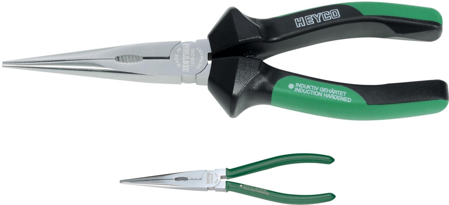
DIN ISO 5745, CPD = verchromt, Kopf poliert, Griffe kunststoffbeschichtet, CPI = verchromt, Kopf poliert, formel plus Kunststoffgriffe mit Abgleitschutz, mit zusätzlich induktiv gehärteten Schneiden, mit langen Backen und gezahnten Greifflächen, mit gezahnter Aussparung, für mittelharten Draht
