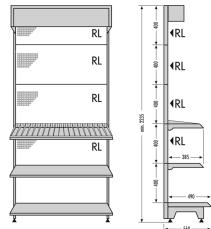
L = lackiert (schlag- und kratzfest durch Kunststoff-Pulverbeschichtung) aus 1,25 mm starkem Stahlblech, Rundlochung (RL), 5 einhängbare Tafeln 1000 x 400 mm, davon 4 Tafeln gelocht, 3 glatte Ablageböden, 1 Einteilungs-Satz mit vorderer und hinterer Abteilschiene und 20 Trennbleche sowie Preisschiene für mittleren oder oberen Ablageboden, mittlerer und oberer Ablageboden schrägstellbar, mit Bodenausgleichsfüßen und Beleuchtungseinheit.
