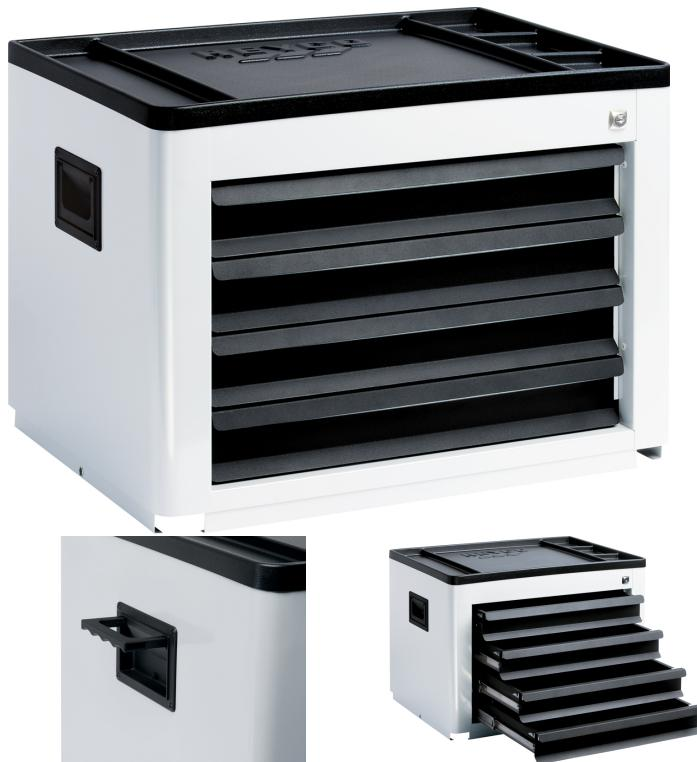
Maße 600 x 440 x 450 mm. L = lackiert, mit 4 Schubladen, Arbeitsplatte aus Kunststoff, Zentralverschluss durch Zylinderschloss, 2 ausklappbare Haltegriffe, geeignet als Aufsatz für Werkstattwagen HEYCO No. 1129
