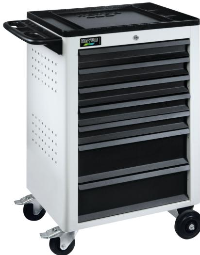
7 Schubladen mit Kugelführungen, die 2 unteren Schubladen mit großem Staufach, mit 4 Rollen, davon 2 Lenkrollen, feststellbar, aus Stahlblech, lackiert, ca. 30 kg Belastbarkeit pro Schubfach, Leergewicht ca. 58 kg, Tragfähigkeit bis 400 kg.
