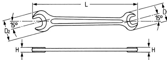
DIN 895 / ISO 3318, PH = phosphatiert, (6 x 7–55 x 60 mm), L = lackiert (65 x 70 –75 x 80 mm)
