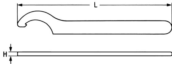
DIN 1810 A, B = brüniert, für Nutmuttern DIN 1804
