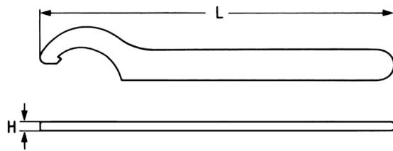
DIN 1810 A, B = brüniert, für Nutmuttern DIN 1804
