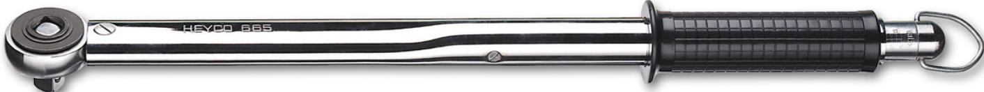
30 Zähne · Meßbereich: Nm 15–70, kpm 1,5–7, ft./lbs. 10–50, verchromt, ganz poliert, mit eingebauter Durchsteckknarre, Verwendung für Rechts- und Linksgewinde, Einstellung durch Rändelschraube am Griffende, automatische Auslösung mit akustischem und fühlbarem Signal bei Erreichen des eingestellten Drehmoments. Genauigkeitsgrad  $\pm 4\%$
