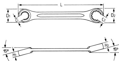
DIN 3118, Chrom-Vanadium, C = verchromt, für Überwurfmuttern an Rohrleitungs-Verschraubungen
