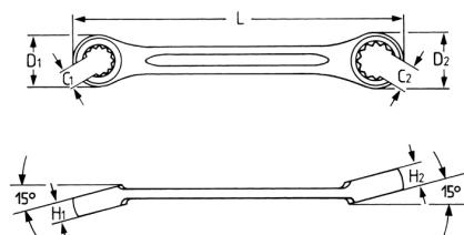
DIN 3118, Chrom-Vanadium, C = verchromt, für Überwurfmuttern an Rohrleitungs-Verschraubungen
