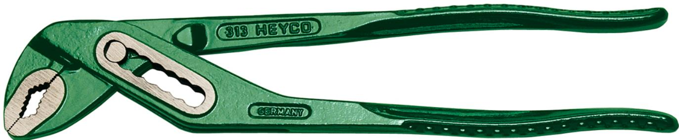
DIN ISO 8976, Chrom-Vanadium, LS = lackiert, Kopf geschliffen, mit durchgestecktem Gleitgelenk
